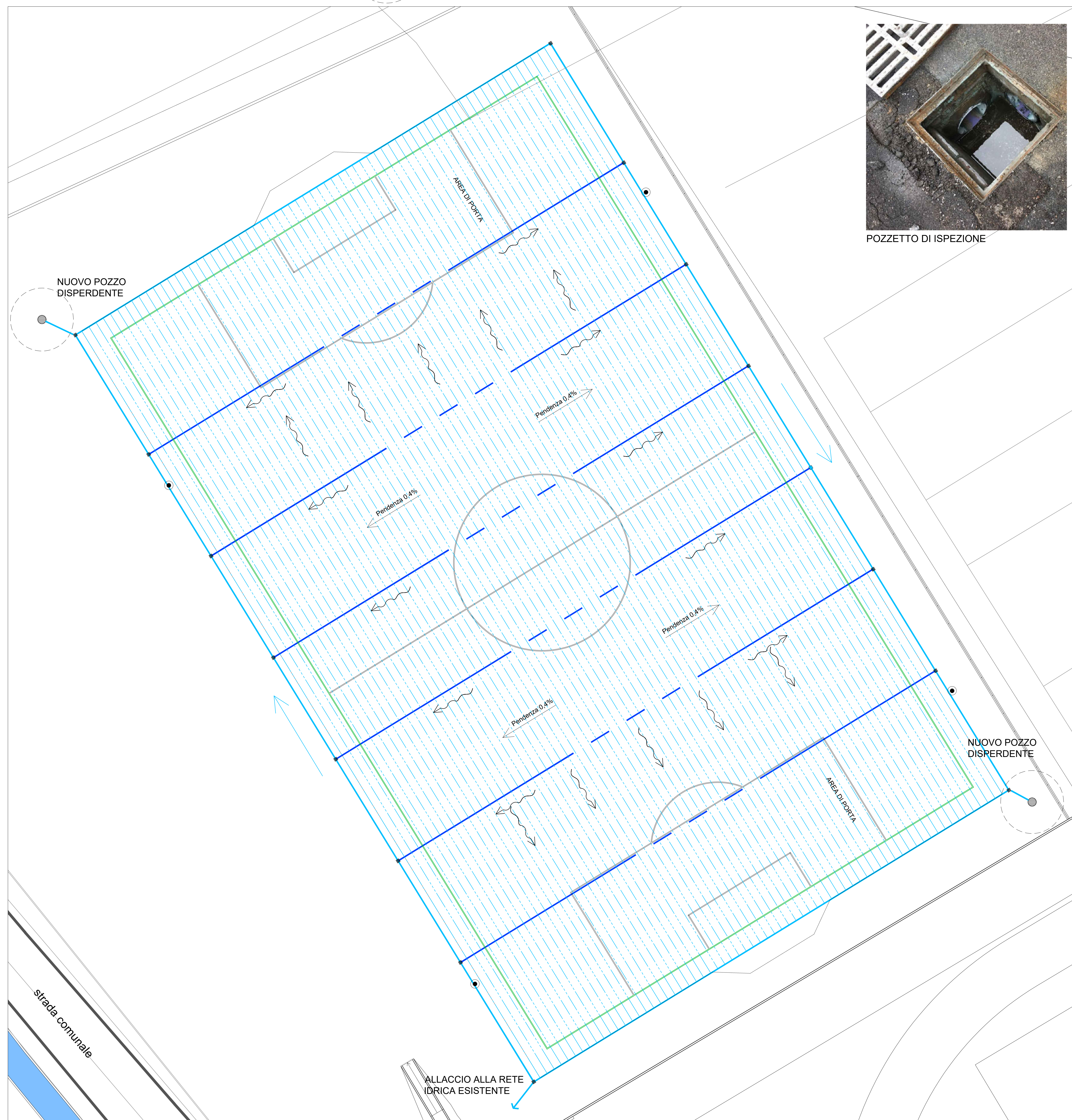
PLANIMETRIA NUOVO SISTEMA DI DRENAGGIO SUPERFICIALE E PROFONDO scala 1:200
